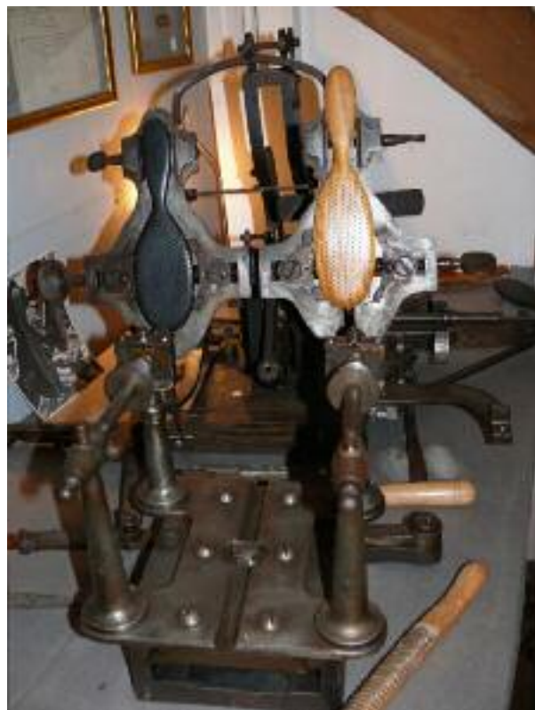
Une machine semi-automatique de double perçage.
